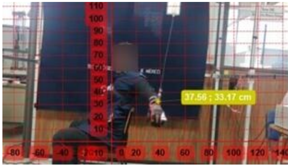
Figura 11. Sistema de coordenadas para determinar las posiciones en el movimiento de circunducción (EP).
